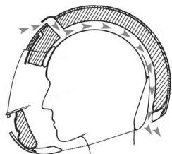
Zur Belüftung der Kopfoberfläche befindet sich an der Oberseite der Helm- schale ein Lufteinlass. Die durch diesen eintretende Luft wird über Kanäle an die Kopfoberseite geführt. Im Helminnenraum ermöglicht das innovative Polsterungssystem den direkten Kontakt zwischen einströmender Luft und Kopfoberfläche, wodurch eine schnellere Ableitung der Feuchtigkeit und Innenraumwärme erzielt wird.
